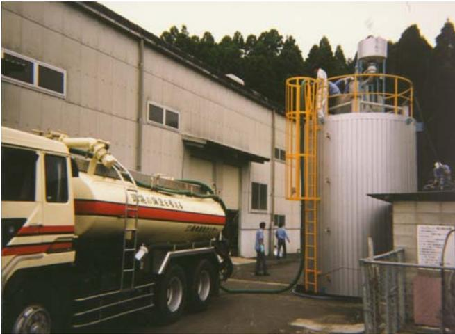
Este equipo para la producción de biogás se utiliza como equipo experimental y demostrativo. El uso móvil sirve para tratamiento temporal de cantidades pequeñas de aguas residuales orgánicas muy contaminadas.
