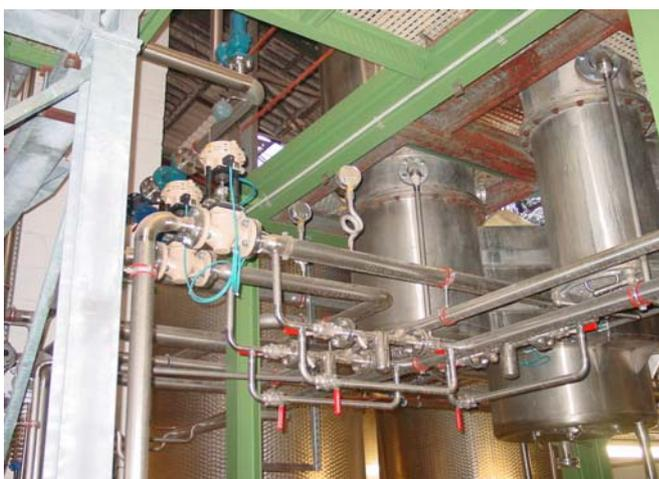
De una manera simple se puede decir que el aceite de colza crudo se mezcla con metanol y lejía de potasio que cumple la función de catalizador. El biodiésel crudo se separa del producto secundario, la glicerina, en un tanque para separación en fases. En los pasos siguientes el biodiésel crudo se lava, seca y refina para que este combustible ecológico alcance la calidad necesaria según la DIN 51 606 o la EN 14214, y lo puedan usar tanto coches como camiones.
